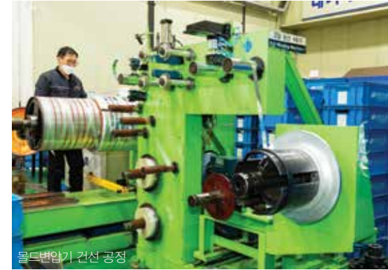
몰드변압기 건설 공정
