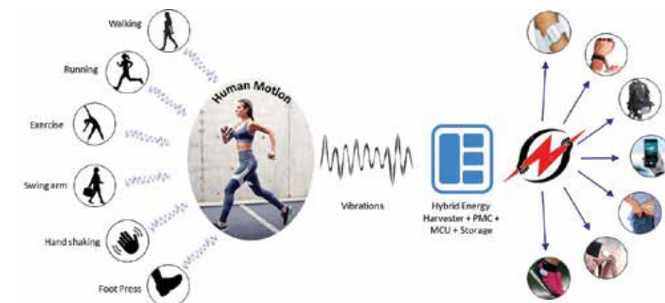
인체 동력 기반 고출력 하이브리드 에너지 하베스팅 기술의 스마트폰 및 웨어러블 스마트기기 응용 개념도 (한국연구재단 중견연구 사업계획서, 2020년)
